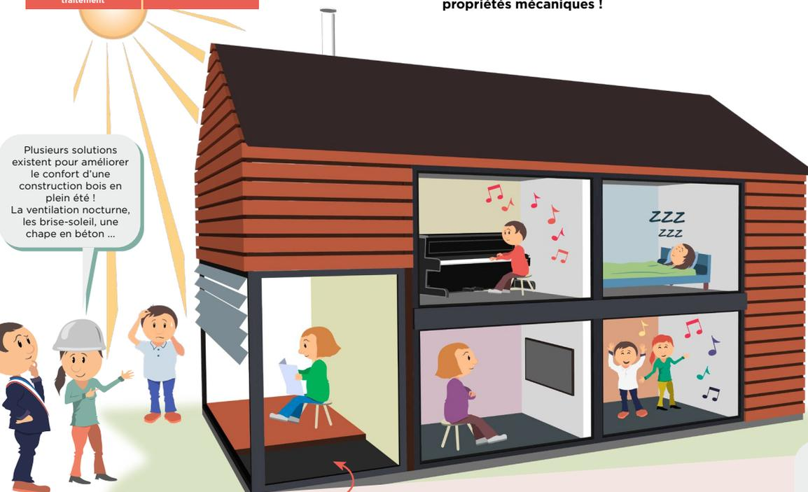
Plusieurs solutions existent pour améliorer le confort d'une construction bois en plein été ! La ventilation nocturne, les brise-soleil, une chape en béton ...
