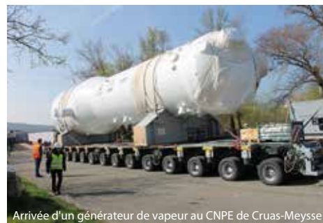
Arrivée d'un générateur de vapeur au CNPE de Cruas-Meysse
