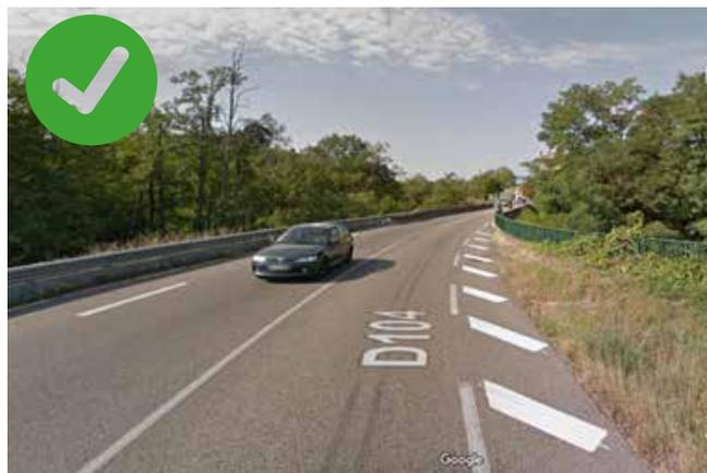
*Fin de surlargeur sur ouvrage matérialisée par un zébra et une réduction progressive*
