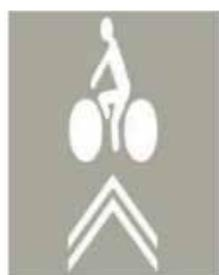
Possibilité de matérialiser la trajectoire des cyclistes sur chaussée lorsque ceux-ci n'ont pas de couloir réservé (en bord de chaussée sans marquage de rive, au milieu de la voie ou transversalement)
